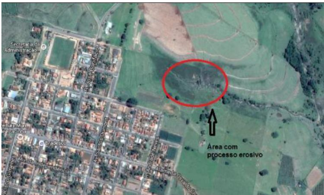
Figura 22: Área degradada pelo lançamento de águas pluviais, na sub-bacia 1 (Ribeirão dos Macacos)
